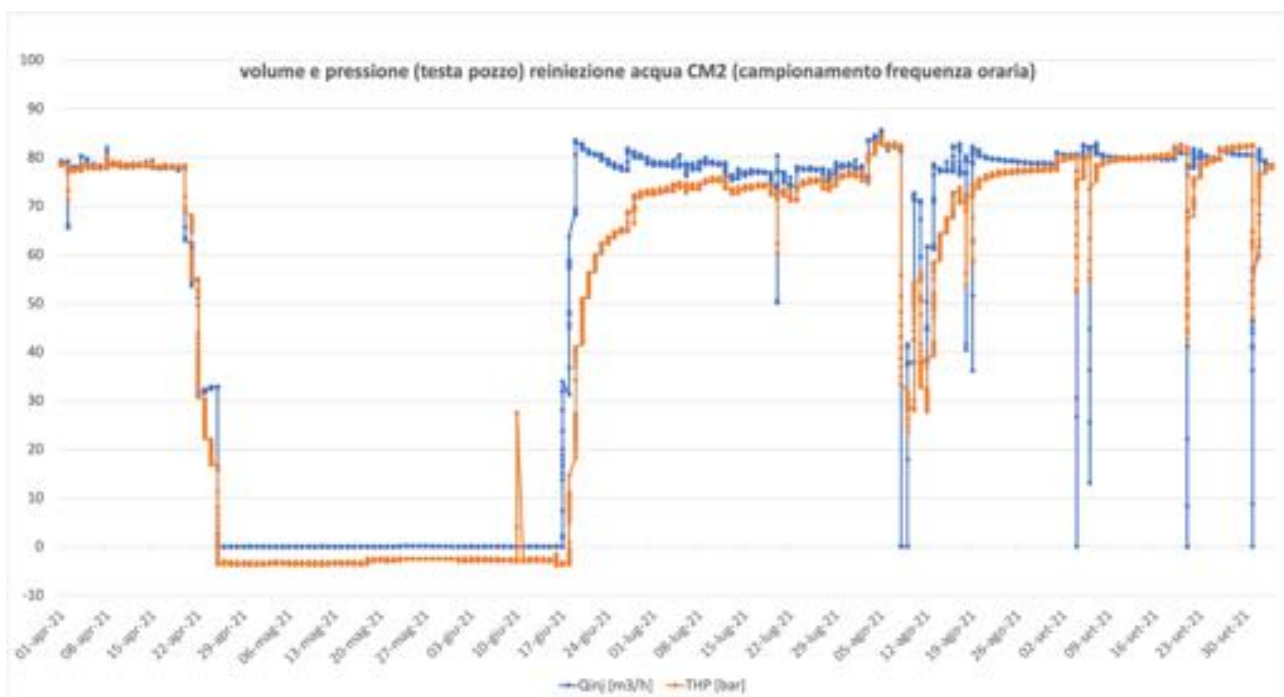
Figura 11. Volume ( m^3/h ) e pressione della reiniezione di acqua a CM2.
