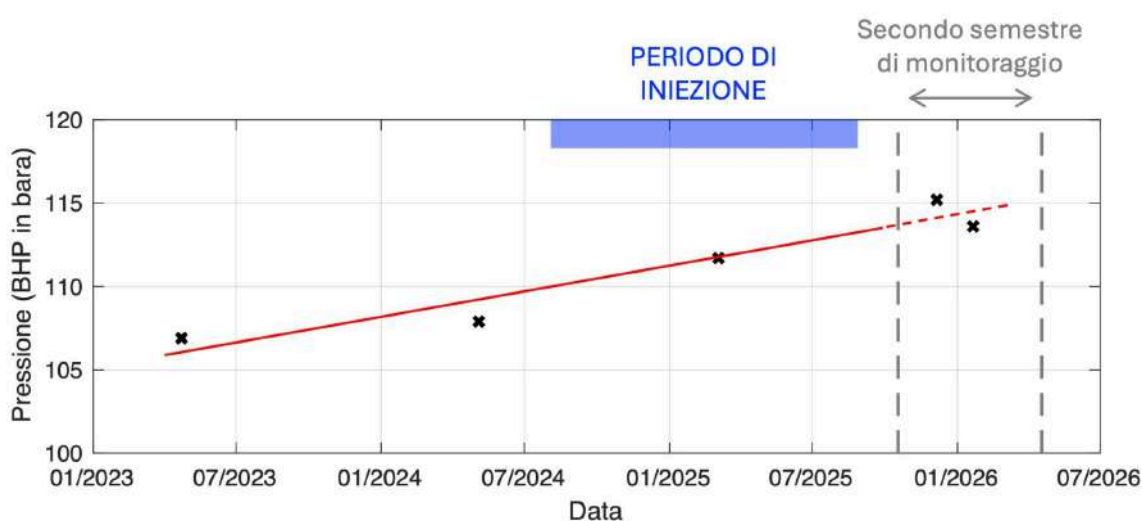
Figura 8.1 Misure di pressione di giacimento relative al pozzo di monitoraggio PCMWB-09D e riferite al livello PL2-C. Le misure (croci nere) sono confrontate con un modello di interpolazione lineare (linea rossa).
