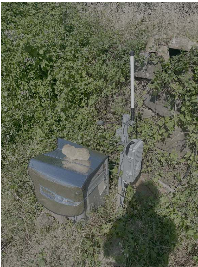
Figura 2.2: Copertura dei box delle stazioni con pannello riflettente.
